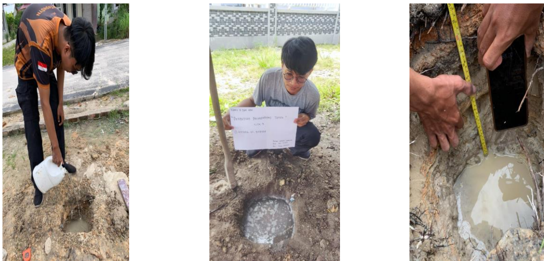
Gambar 2. Pengujian permeabilitas dan pengukuran elevasi muka air tanah
