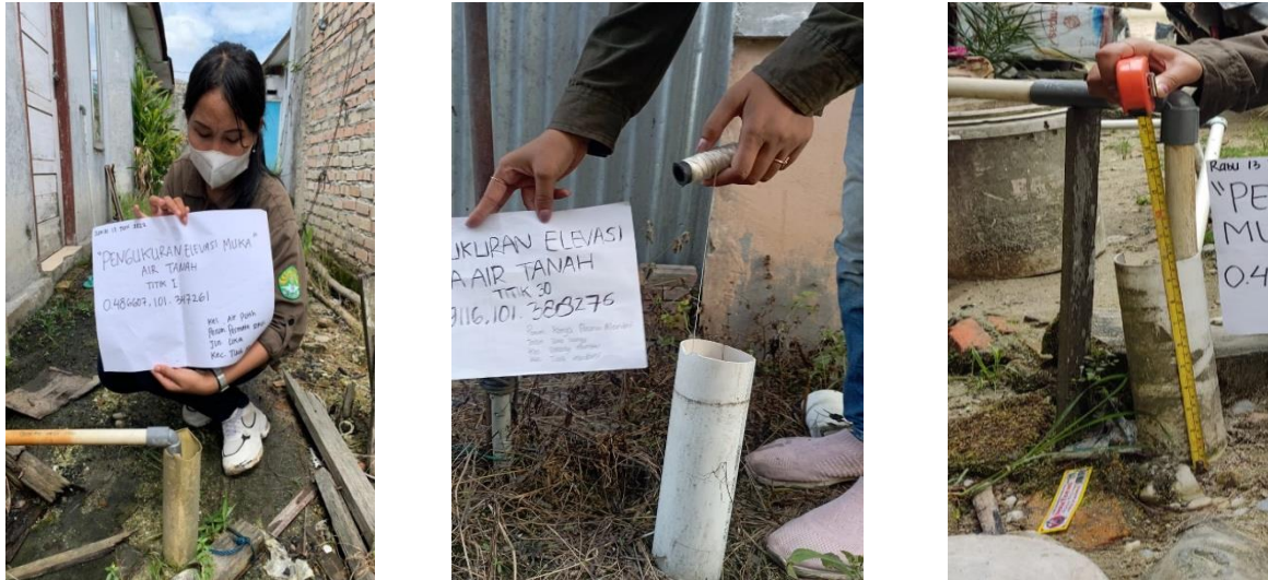
Gambar 3. Pengukuran Elevasi muka air tanah pada salah satu sumur bor warga
